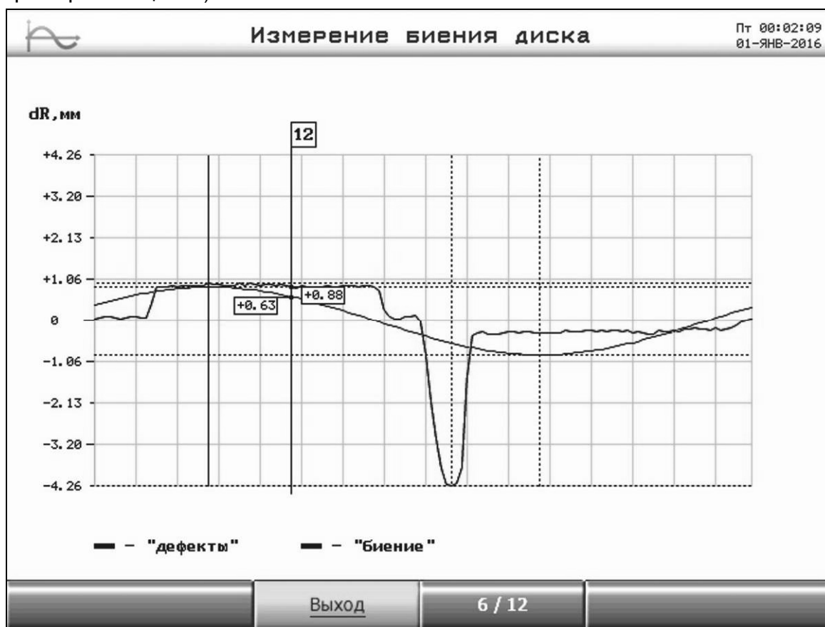
Рисунок 7.6 – Окно измерения биений диска
